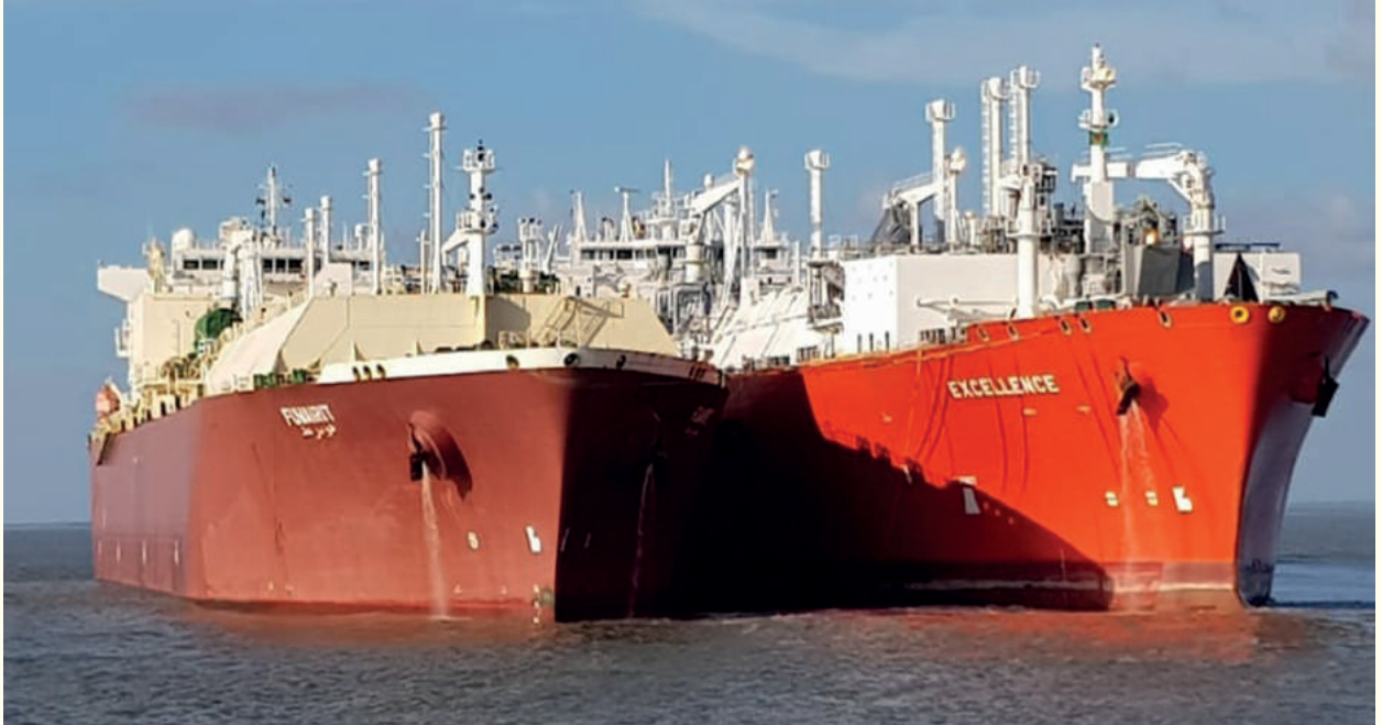
মহেশখালীতে এলএনজি কার্গো জাহাজ Fuwairit থেকে এলএনজি টার্মিনাল Excellence এ STS পদ্ধতিতে এলএনজি ট্রান্সফার।
